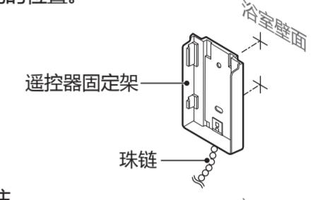
(2) 在标示固定螺丝孔的位置开好 $\varnothing 6mm$ 、深度40mm的孔,注入硅胶后打入膨胀管。
