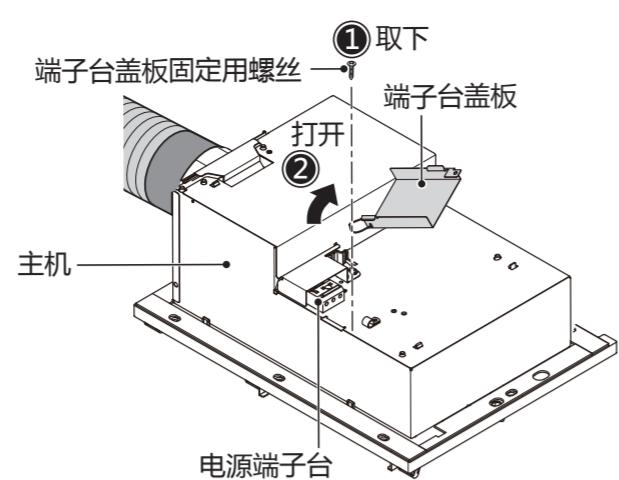
(2) 将电源线(截面积2.5mm²)以及接地线(截面积2.5mm²)连接到电源端子台上。
