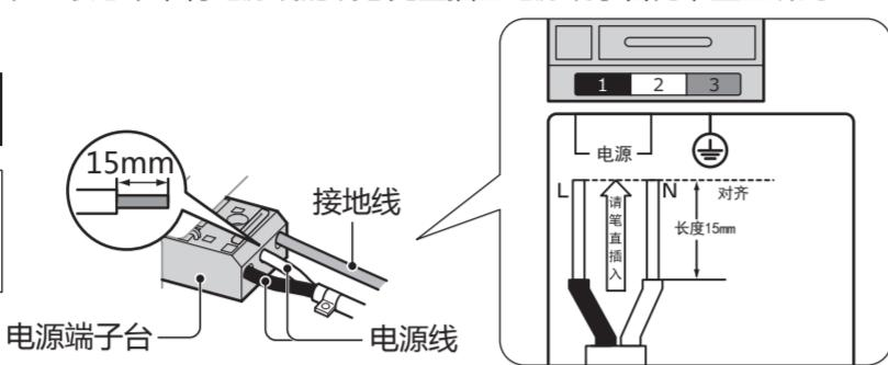
· 将电源线的线芯留出相同的长度，将线芯笔直的插入到电源端子台内。 · 请勿在电源端子台附近弯折电源线。否则可能会造成电源线前端不能完全地插入电源端子台内。
