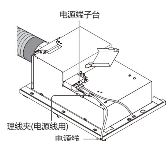
(4) 安装端子台外盖，用端子台外盖固定螺丝固定端子台外盖。
