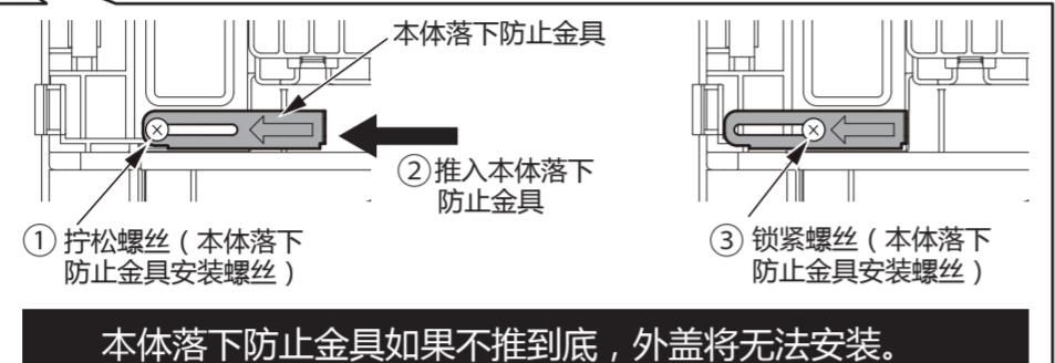
本体落下防止金具如果不推到底,外盖将无法安装。
