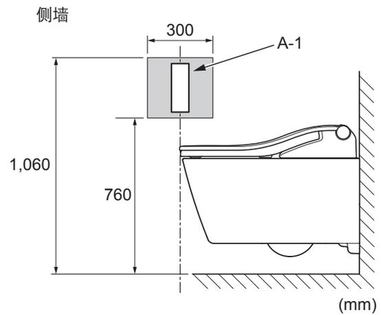
**20** 暂时安装在步骤 19 中所决定的位置后，请确认A-1的信号接收状态。
