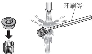
5. 将进水过滤网安装在封盖上
